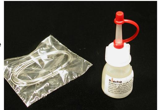
1. Tauchen Sie den zu lötenden Draht in das Flussmittel oder benetzen Sie die Lötstelle mit Flussmittel
